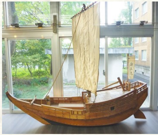
和船模型(菱垣廻船) 製造年月日不詳 (東京海洋大学明治丸海事ミュージアム所蔵)
